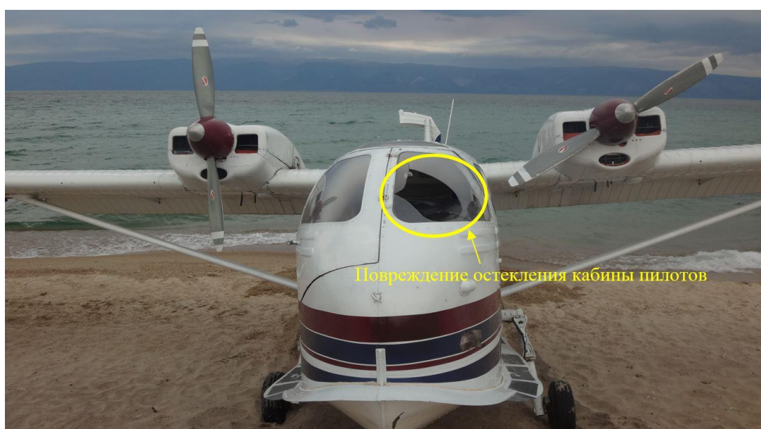
Рис. 4. Повреждение остекления кабины пилотов. Фото 17.08.2018
