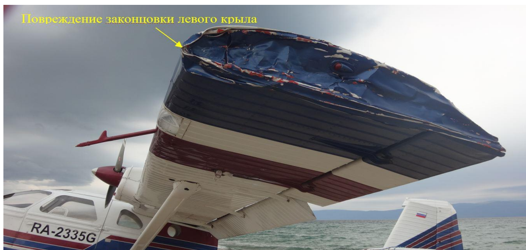
Рис. 3. Повреждение законцовки левой консоли крыла. Фото 17.08.2018
