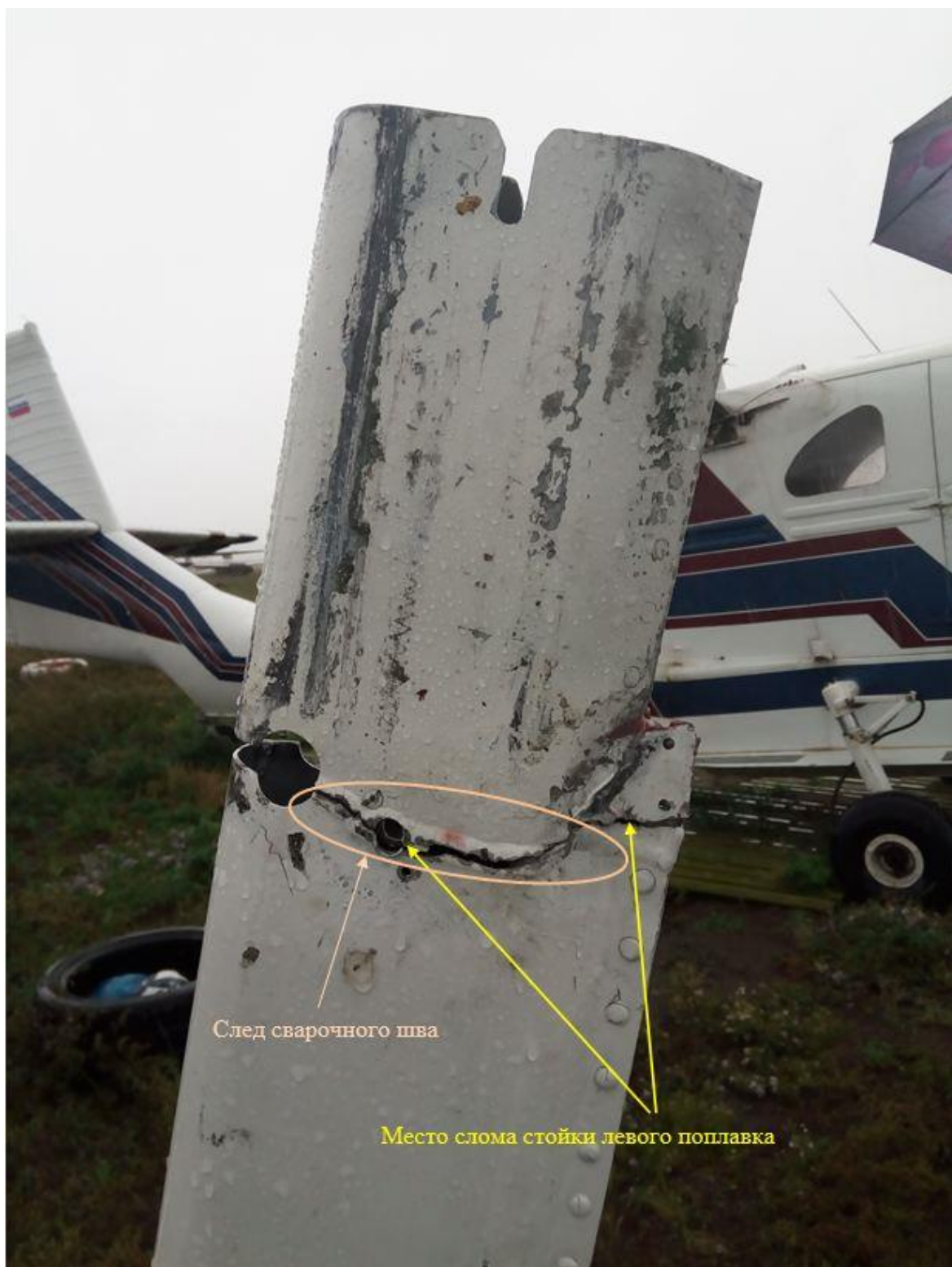
Рис. 6. Место слома стойки левого поплавка
